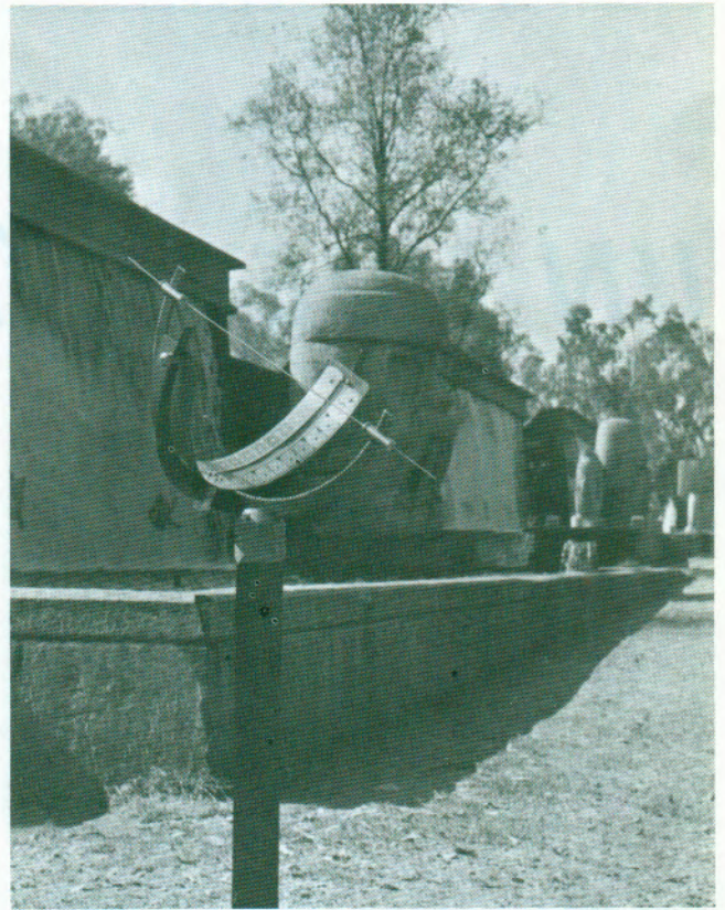
“Olmeca”, reloj solar ecuatorial con indicaciones de la hora solar verdadera y hora solar media sitio de colocación. Diseñado en 1985.
